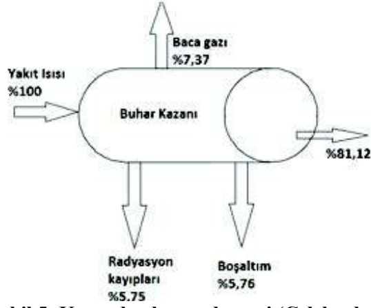
Şekil 5: Kazanda olan ısı dengesi (Celeb vd. 2016)
